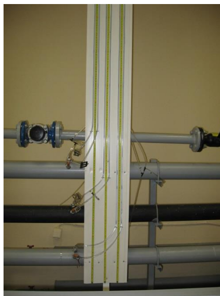
Рисунок 3.6 Фрагмент стенда с пьезометрами
