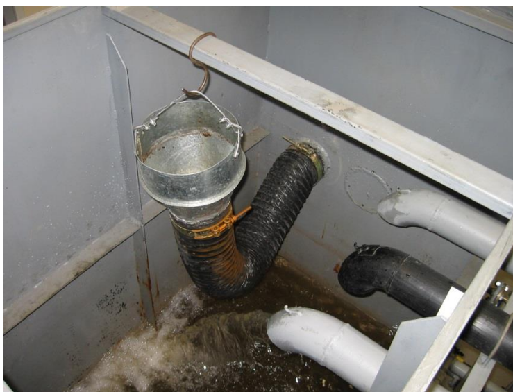
Рисунок 4.3 Узел отбора проб с воронкой и гибким шлангом
