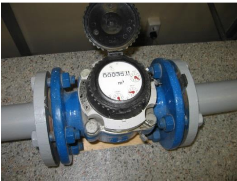
Рисунок 3.4- Общий вид турбинного расходомера (а) и дисплей ультразвукового расходомера (б)
