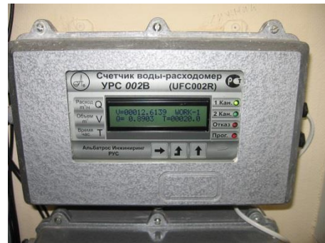
Рисунок 3.4- Общий вид турбинного расходомера (а) и дисплей ультразвукового расходомера (б)
