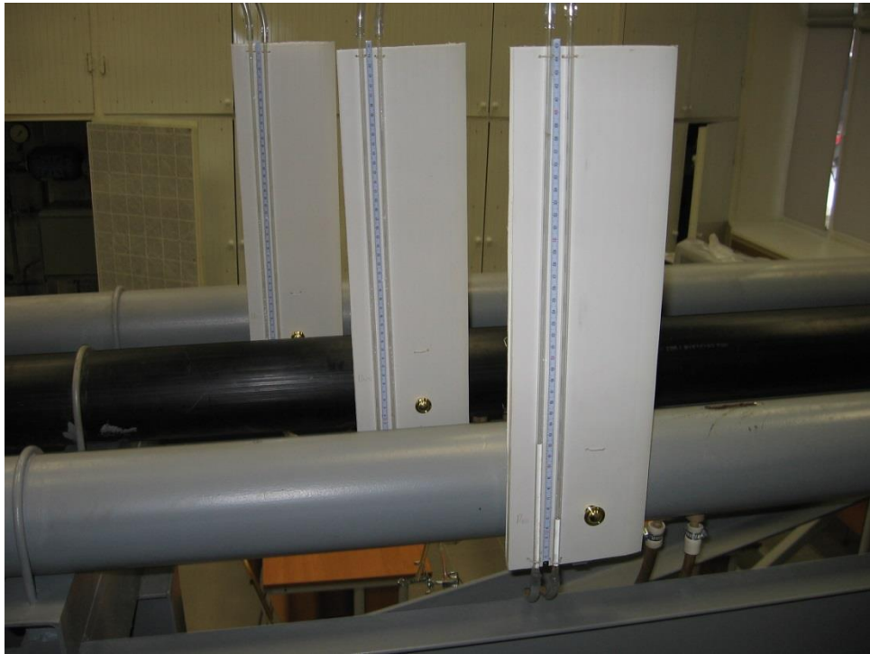
Рисунок 4.2 Узел крепления пьезометров на трех параллельных трубопроводах.
